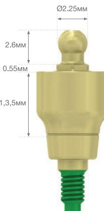
Усилие при финальной затяжке шаровидных абатментов - 30Н/см.
